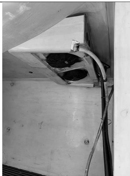
*Imagem Sistema de Refrigeração do veículo*
